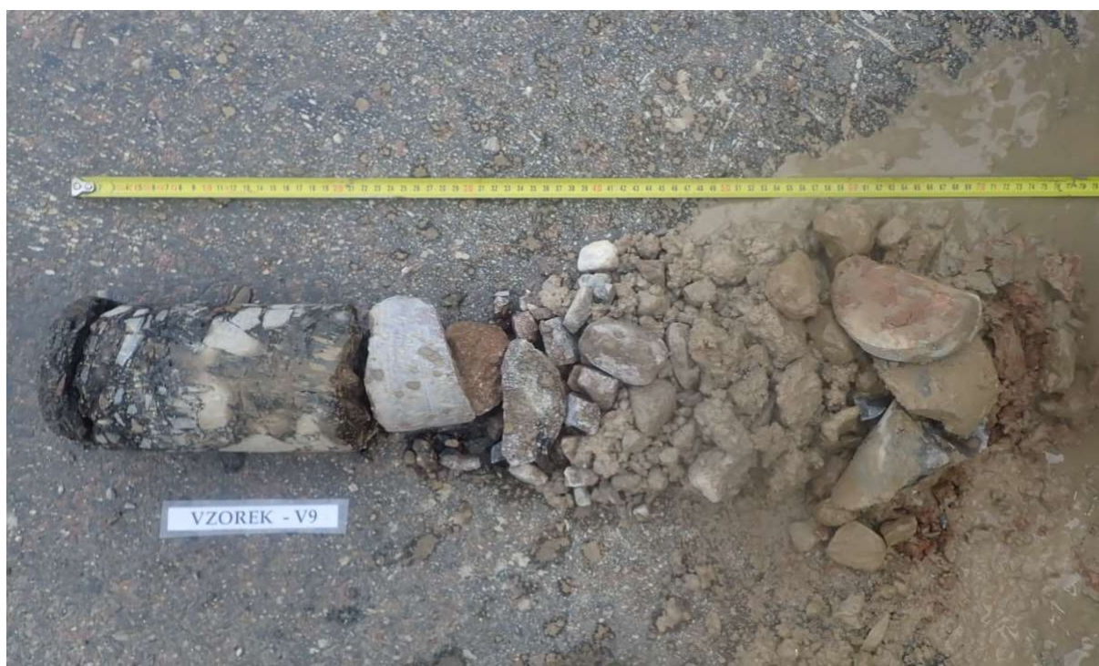
Obr. 1 - Jádro vývrtu Vzorek – V9 (in situ).
