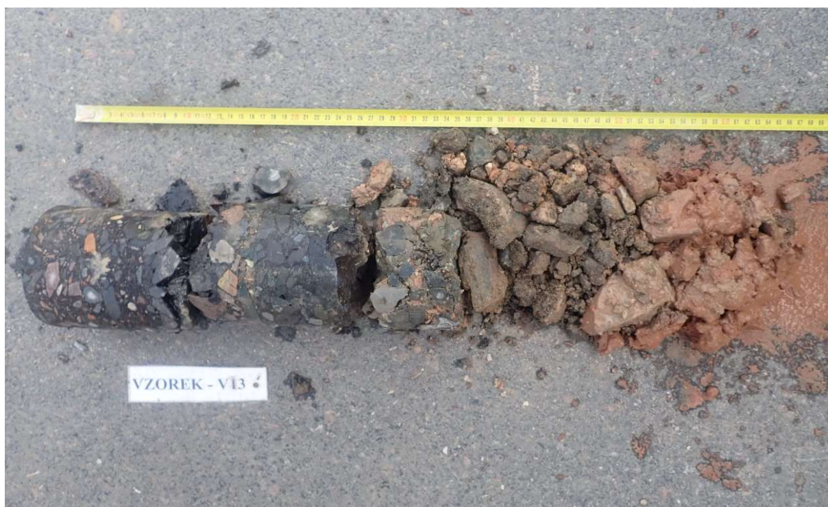
Obr. 9 - Jádro vývrtu Vzorek – V13 (in situ).
