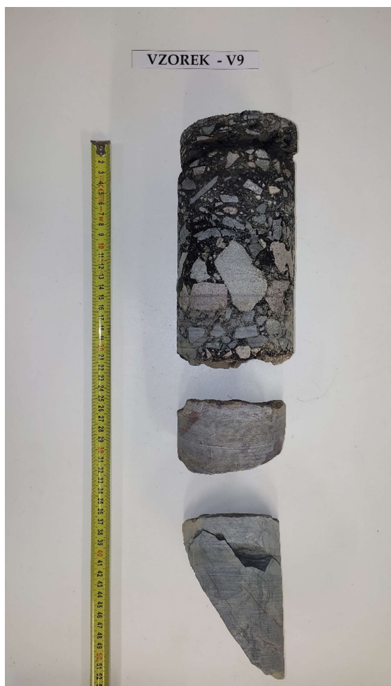
Obr. 2 - Jádru vývrtu Vzorek – V9 (laboratoř).
