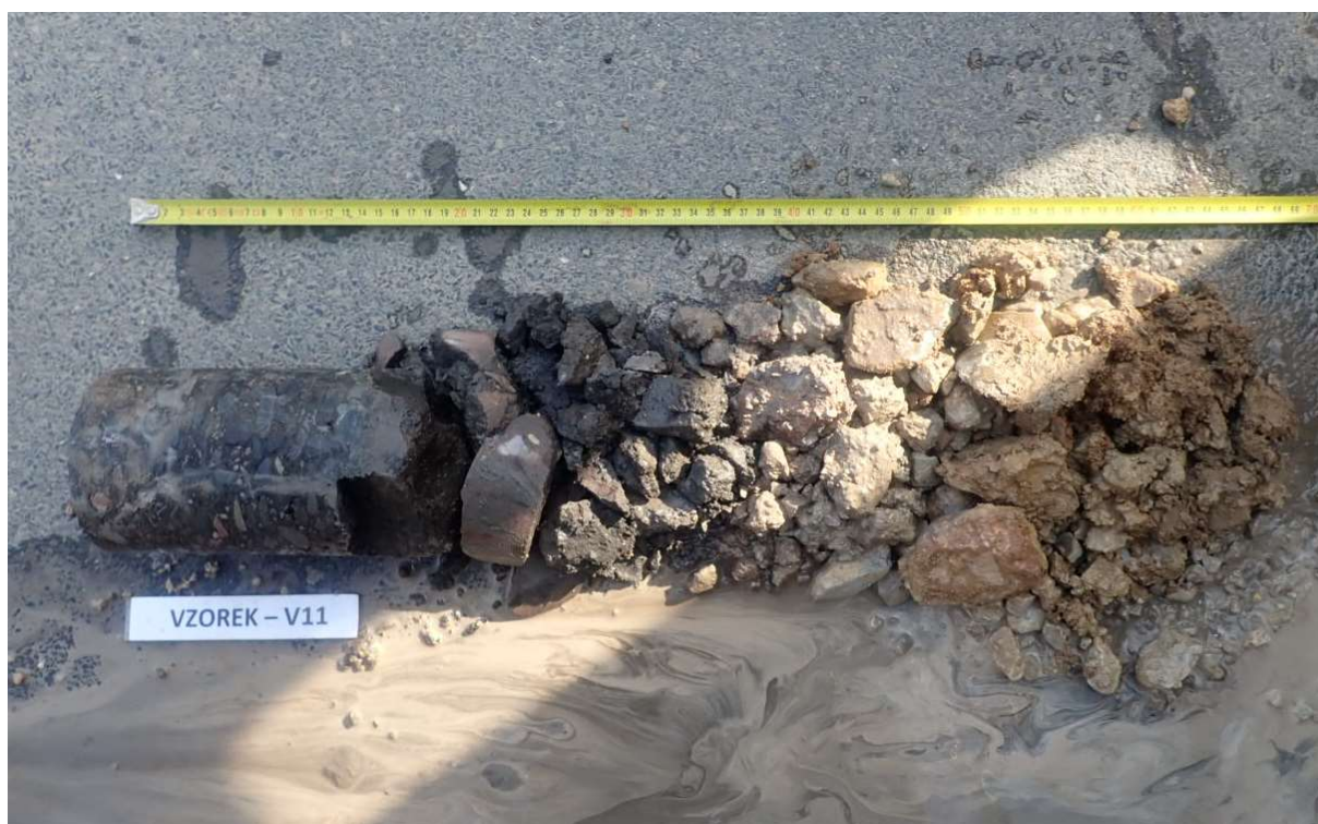
Obr. 5 - Jádru vývrtu Vzorek – V11 (in situ).
