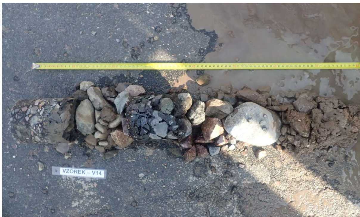
Obr. 11 - Jádro vývrtu Vzorek – V14 (in situ).
