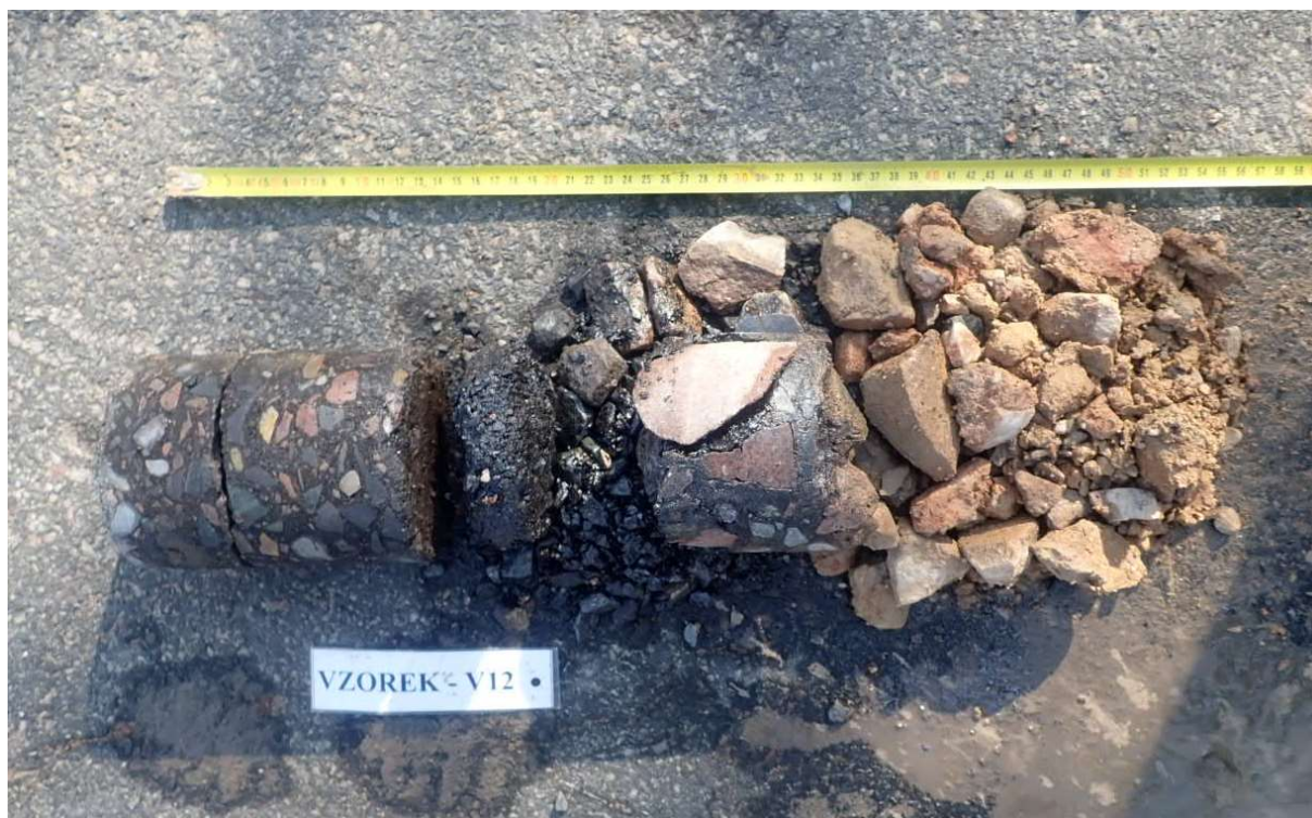
Obr. 7 - Jádro vývrtu Vzorek – V12 (in situ).
