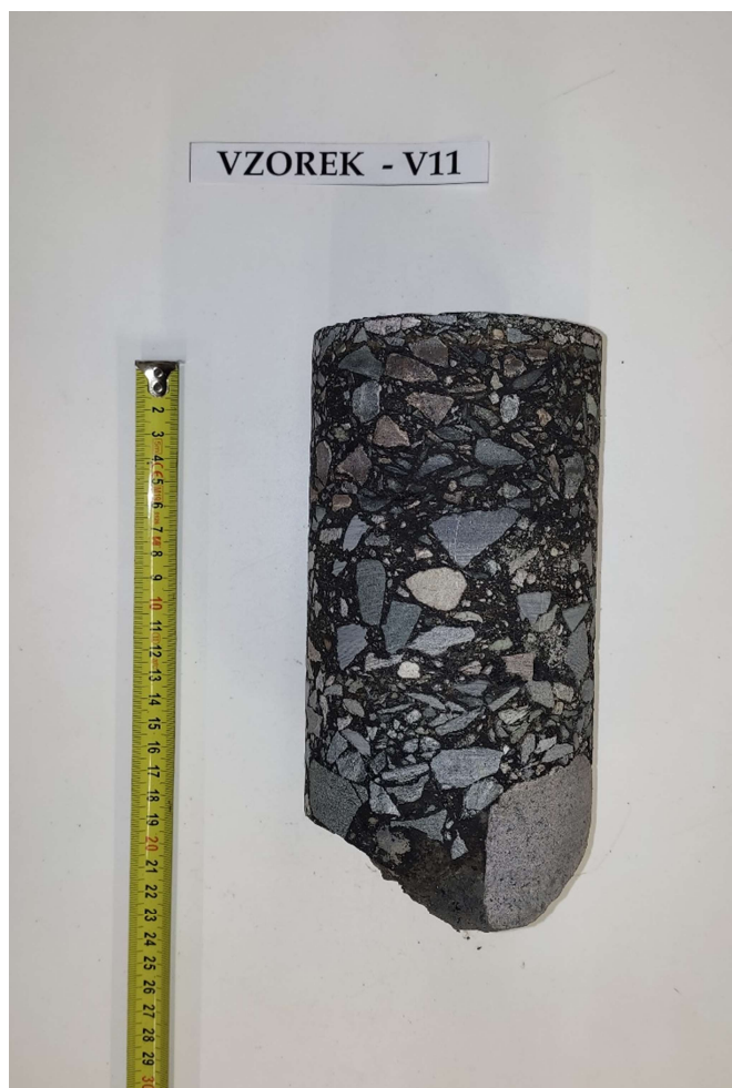
Obr. 6 - Jádru vývrtu Vzorek – V11 (laboratoř).
