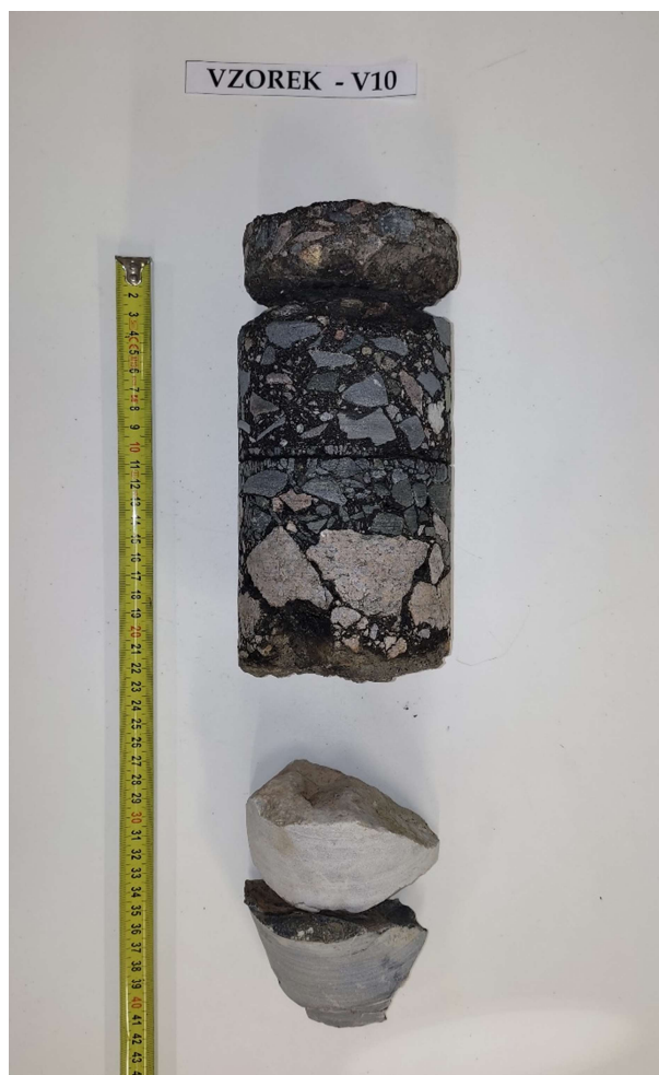
Obr. 4 - Jádro vývrtu Vzorek – V10 (laboratoř).
