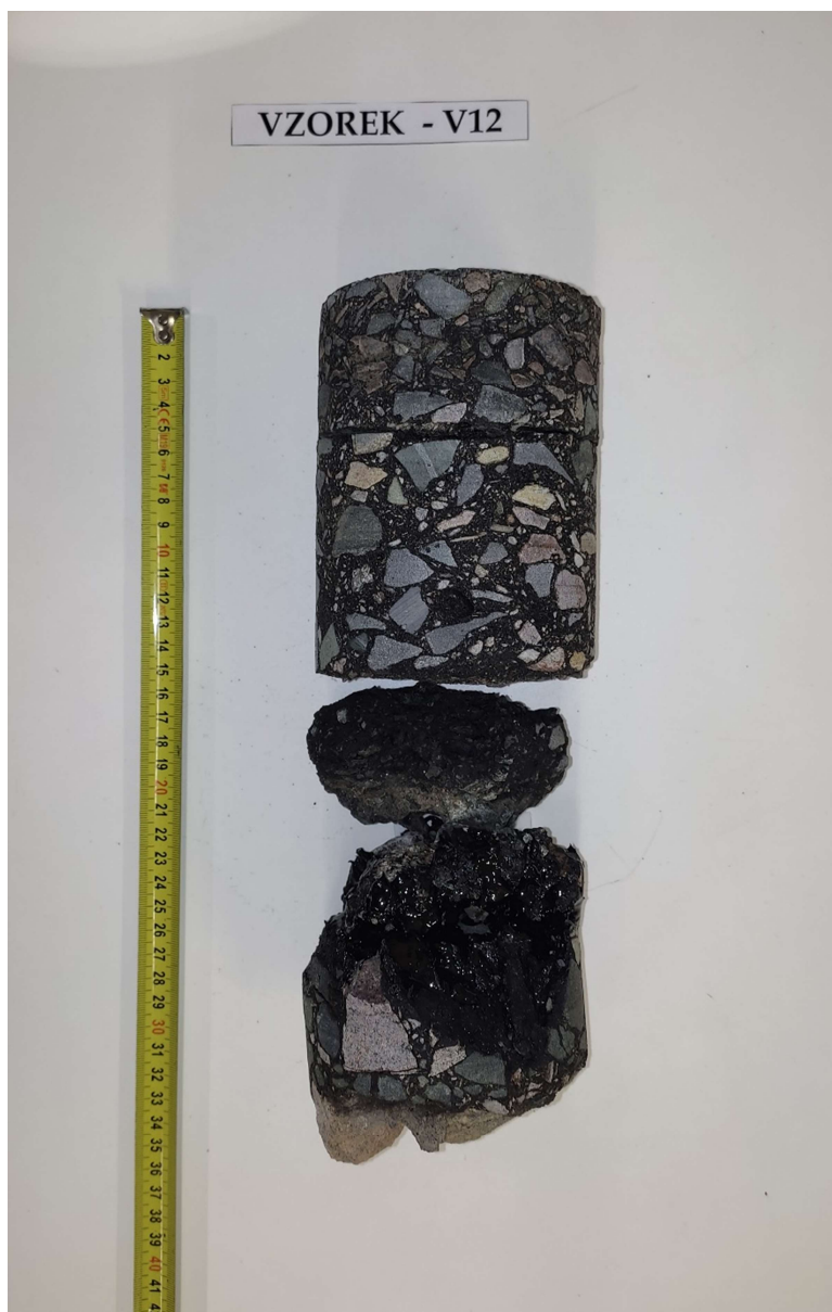
Obr. 8 - Jádru vývrtu Vzorek – V12 (laboratoř).
