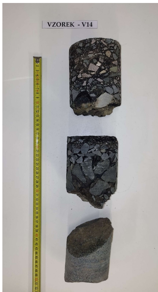
Obr. 6 - Jádru vývrtu Vzorek – V14 (laboratoř).
